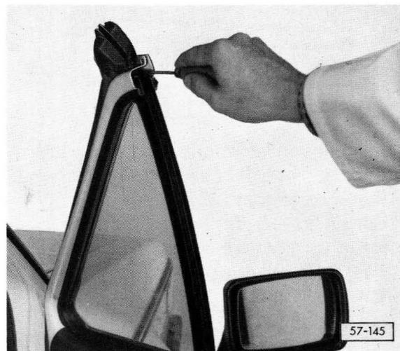
**Abb. 9 Führungsschiene ausbauen**
