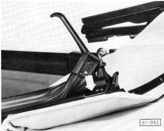
Dachrahmendichtung auf einer Länge von ca. 55 mm von der Klemmschiene abziehen und Anlagefläche in der Klemmschiene mit Siliconkautschuk (AMV 176 005 05) zusätzlich abdichten – Pfeil –.
